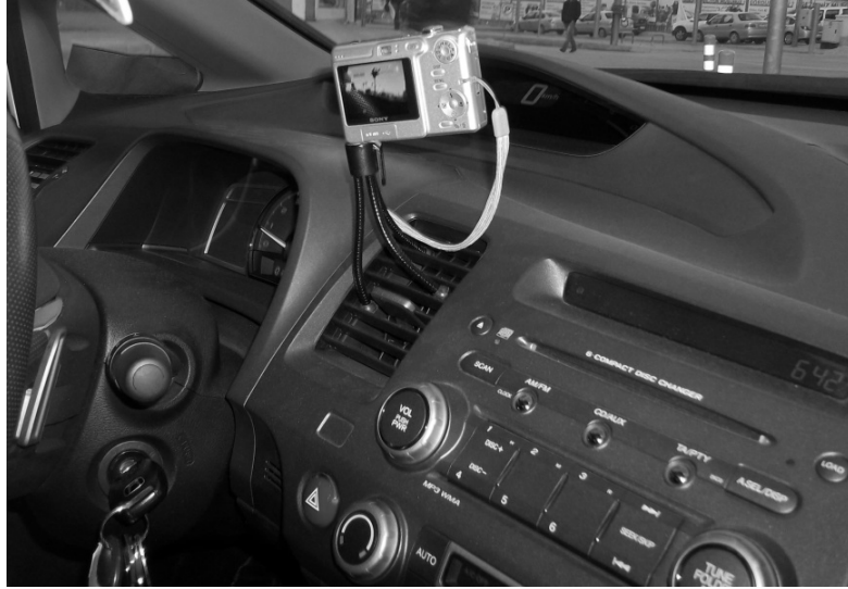
Şekil 4. Aracın digital hız göstergesindeki değerleri filme alan (ses de kaydeden) birinci video kamera ve görüntüsü
