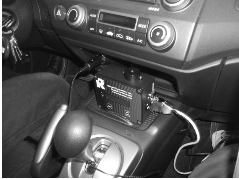
Şekil 3. Elektronik ball-bank cihazının araçtaki konumu
