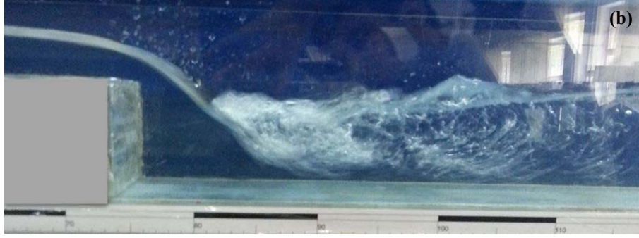
Şekil 2b. Ani düşü sonrası B-tipi hidrolik sıçrama
