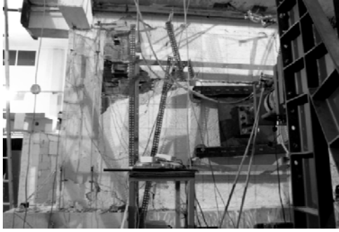
%1.40 - kesme kayması gerçekleşen iç duvarda, duvar bloklarının köşesinde ezilme
