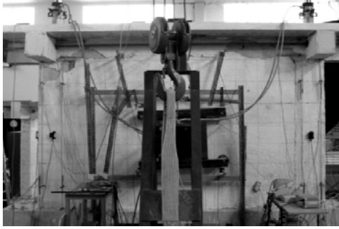
%0.75 - iç kanadın diyagonal çekme ile karışık kesme kayması hasarı.
