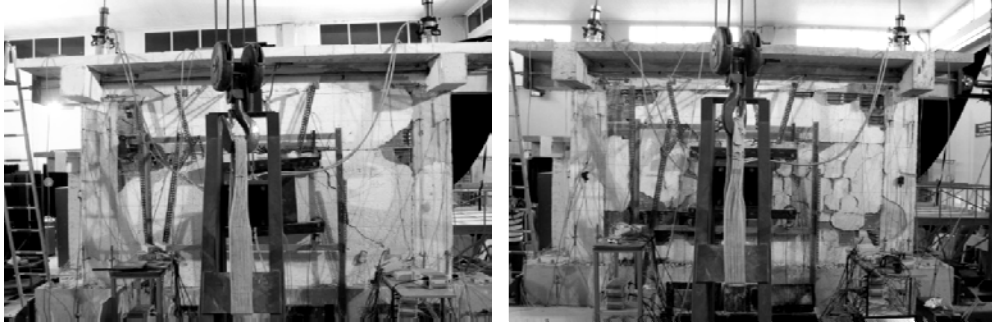
%1.75 - iç kanadın diyagonal kemerlenme ve kesme kayması ile karışık göçme modu.
